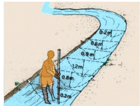
Ilustración 21. Método del flotador, profundidad media, tomado de (FAO, 2019).
